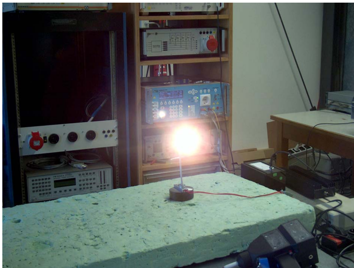
Prüfaufbau Störfestigkeitsprüfung nach EN 61000-4-6 bzw. EN 61000-4-4
