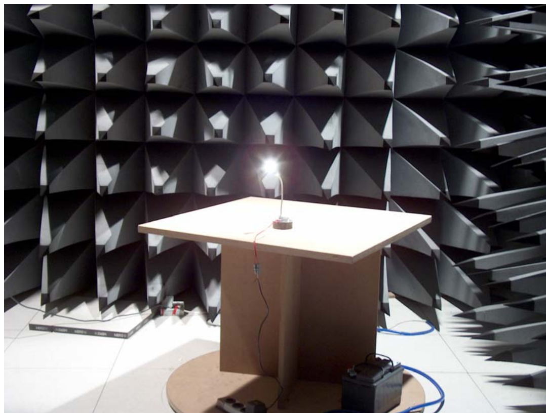
Störfeldstärkemessung in der Absorberhalle
