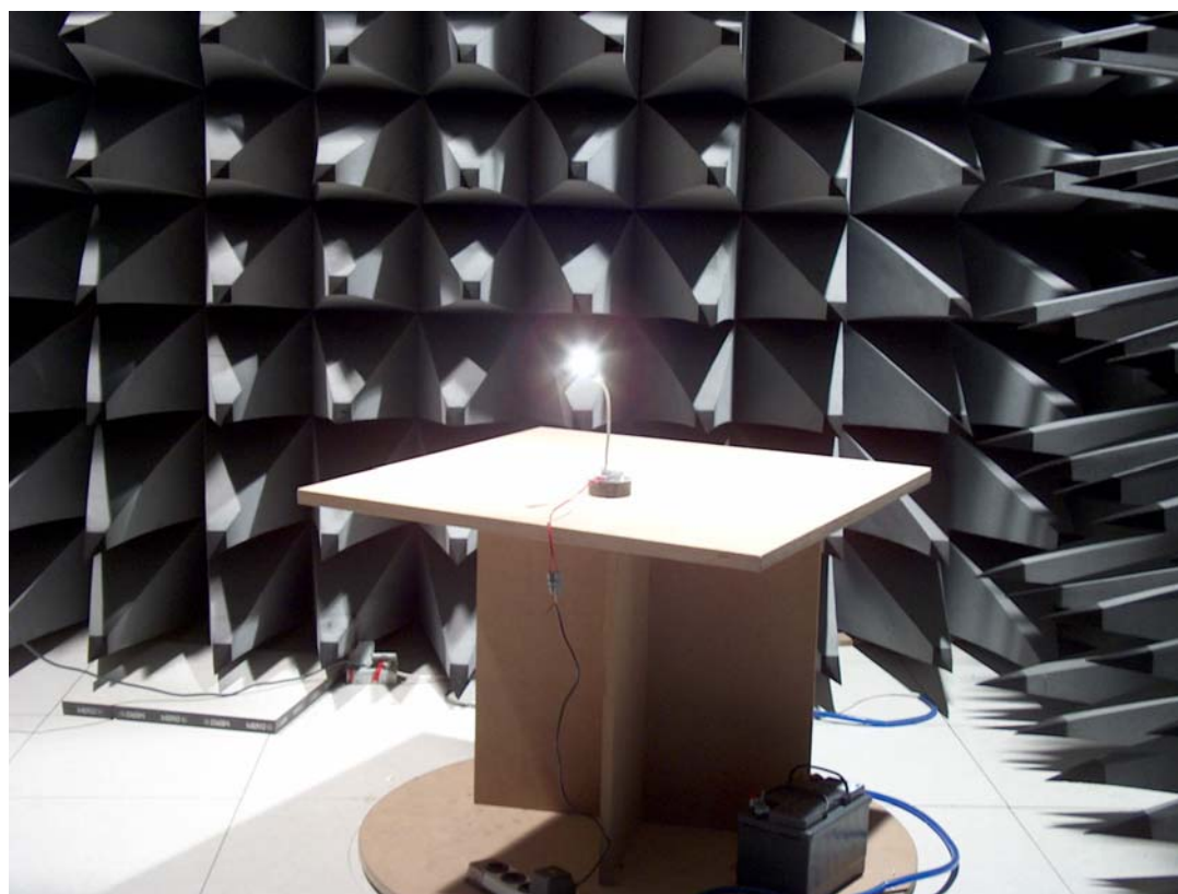
Störfeldstärkemessung in der Absorberhalle
