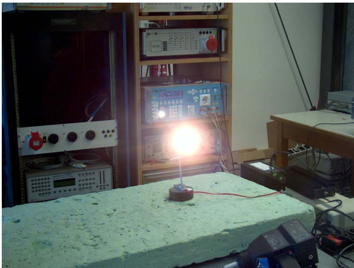
Prüfaufbau Störfestigkeitsprüfung nach EN 61000-4-6 bzw. EN 61000-4-4
